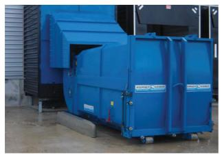
¾ plein et 100% plein, double crochet de préhension, 4 rouleaux diam. 180 mm, étanchéité sur porte arrière, vérin pendulaire.
